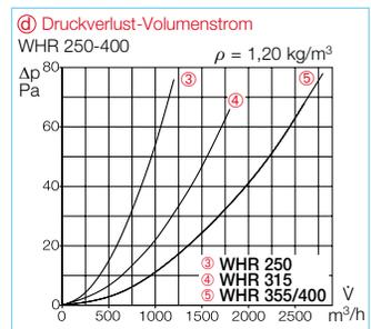
Ⓓ **Ermittlung Druckverlust**
